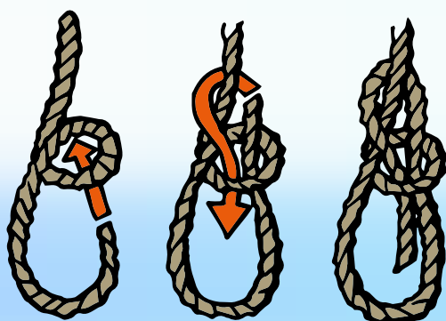
Pælestik – Her kan man binde en løkke, der ikke giver sig, kan bruges til fortøjning
