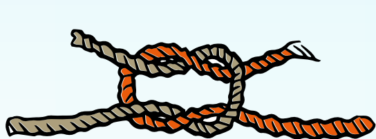
Råbåndsknob – binder man 2 lige tykke stykker tov sammen med
